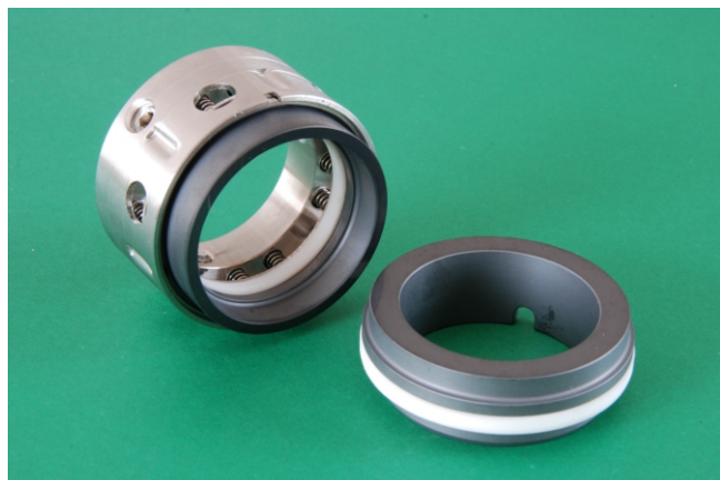
Masywne uszczelnienie wielosprężynkowe niezależne od kierunku obrotów. Pierścienie stali zgodny z normą EN 12756 .
